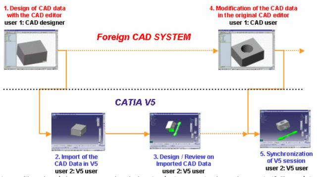
Lorsqu'il est lancé, le programme batch de mise à niveau active le mode associatif. Il met à jour la structure ou la géométrie des données V5 en fonction des modifications effectuées par le concepteur SolidWorks sur les données originales.
